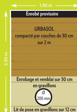
Enrobage d'une canalisation en grès et remblaiement de la tranchée
