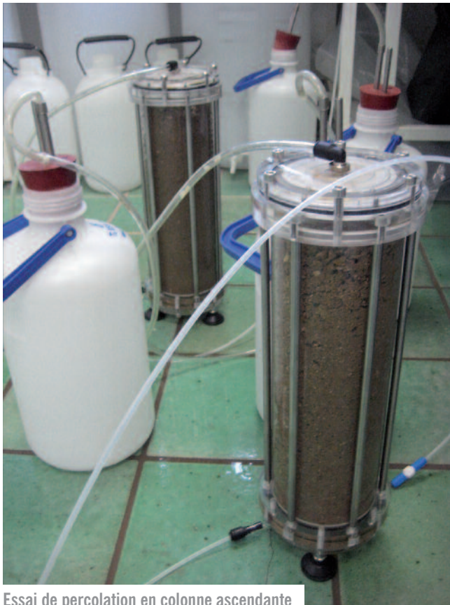
Essai de percolation en colonne ascendante
