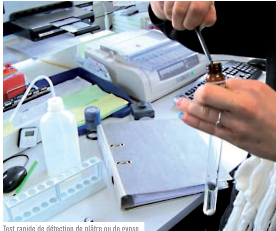
Test rapide de détection de plâtre ou de gypse
