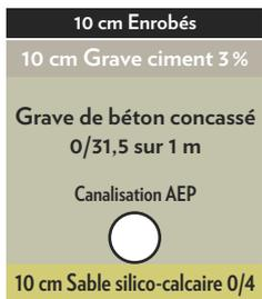
Ainsi, les camions pouvaient à la fois déposer les couches de chaussées et les terres puis repartir à charge en Sable Silico-Calcaire 0/4 (utilisé en lit de pose des canalisations) ou en Grave de Béton Concassé 0/31.5 pour la mise en place en remblai de tranchées. Les matériaux YPREMA ont ensuite été recouverts
