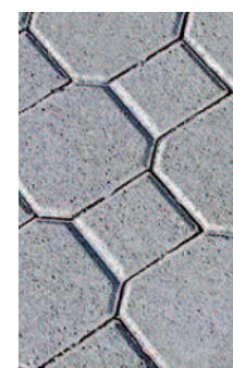
Enrochement en béton et pavés en béton fabriqués à base de grave de mâchefers Granova®
